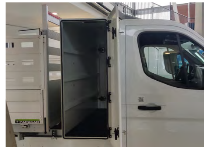
Renault Master XDD Extra 3,5T L3H1 2,0 dCi – třístranný sklopný valník s úložným boxem Paragan Trucks
